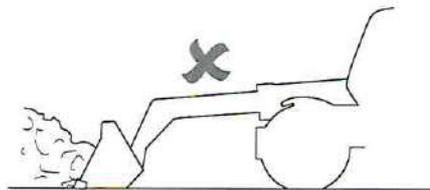
2. Cuando se está cargando desde una pila de material suelto, debe empezarse por abajo y continuar hacia arriba por la cara de trabajo.
